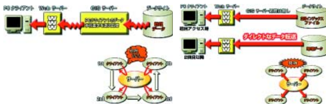
図 5.3-1 三層構造アーキテクチャ（左）と分散処理アーキテクチャ（右） 出典：ドーン HP ( http://www.dawn-corp.co.jp/ )
